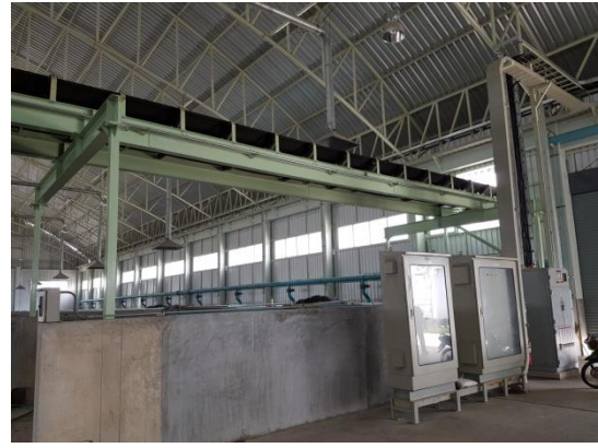
ท่อควบคุมแก๊สและความร้อนในช่องหมักปุ๋ย
