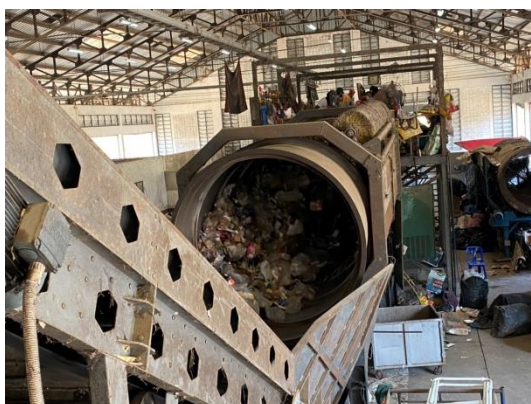
เครื่องจักรคัดแยกและการอัดขยะรีไซเคิล และบ่อฝังกลบภายในสถานที่กำจัดขยะมูลฝอย เทศบาลเมืองน่าน
