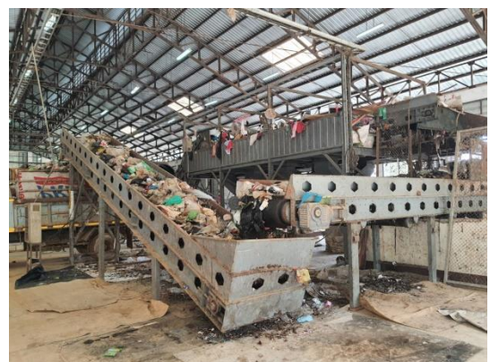
เครื่องจักรคัดแยกและการอัดขยะรีไซเคิล และบ่อฝังกลบภายในสถานที่กำจัดขยะมูลฝอย เทศบาลเมืองน่าน
