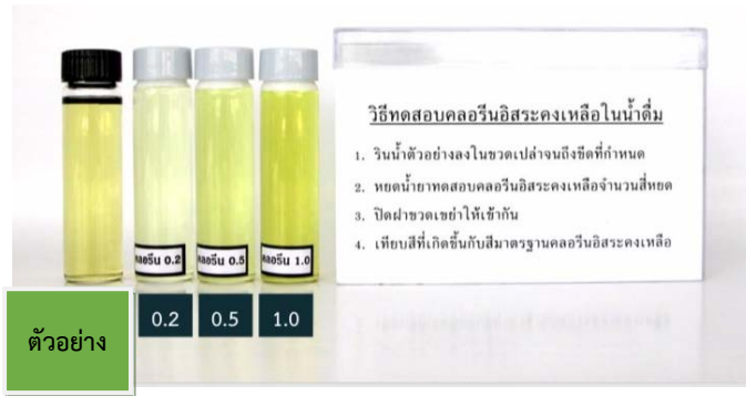
การตรวจสอบคลอรีนอิสระคงเหลือ
